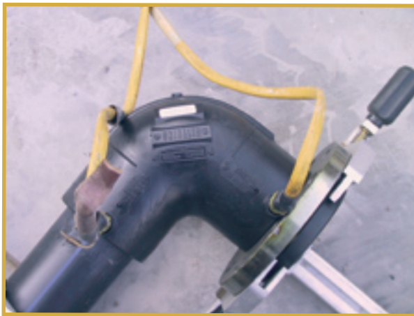
Example of electrofusion jointing Schweißbeispiel für Elektrofusion Пример сварки методом электроплавки
